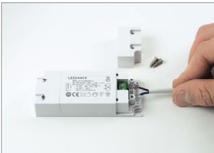
Étape 1: Dévissez le serre-câble du convertisseur On/Off et déconnectez les câbles
