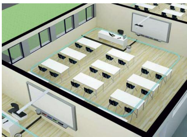
Exemple de boucle magnétique dans une salle de classe.
