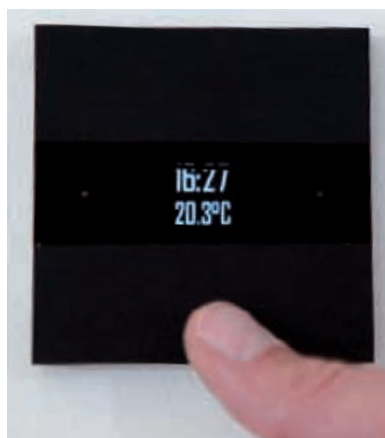
Room controller Basalte Deseo avec variation de lumières, chauffage et volets roulants.
