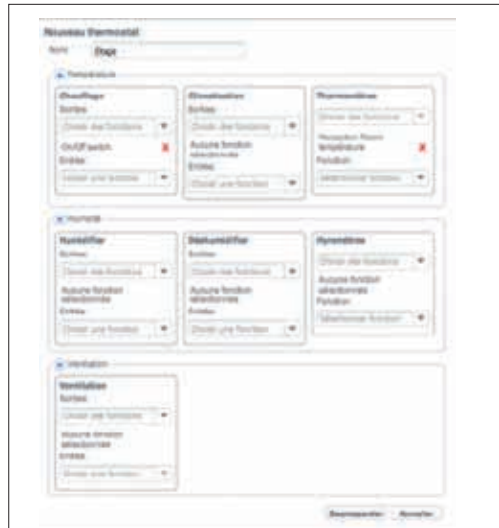
◀ Fig. 4 Widget de gestion du chauffage/ventilation/climatisation très complet.
